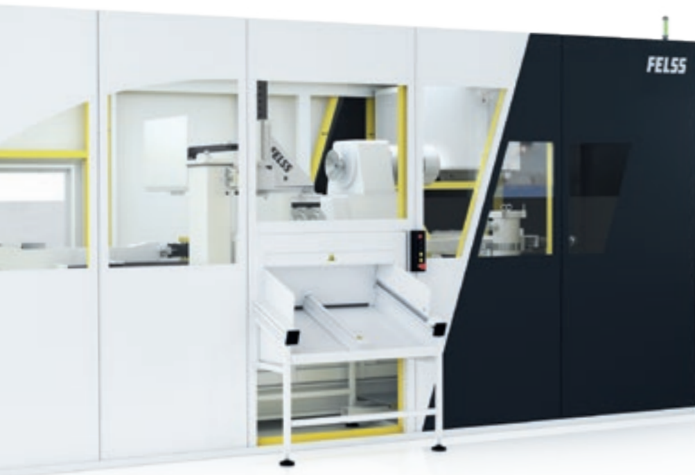
Beispiel für eine vollautomatische Einzelrundknetanlage: Modell HA 60-1VUEH-NC
